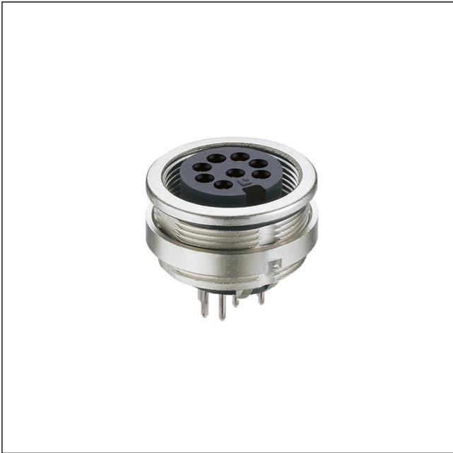
SWUM™-Einbaukupplung nach IEC 61076-2-106 und AISG-Spezifikation, IP68/67, mit Schraubverschluss, für Leiterplatten, manuelle Lötung, für Frontmontage
